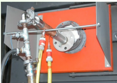
Hochtemperatur-Impaktor im Einsatz
