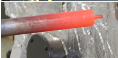
Hochtemperatur-Impaktor unmittelbar nach erfolgter Probenahme
