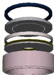
Aufbau einer Impaktorstufe
