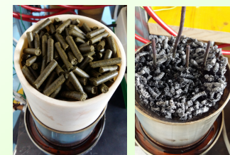
Brennstoff und Rückstände (Aschen) bei einem Testlauf mit Weizenstroh Pellets
