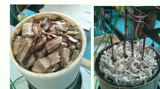
Brennstoff und Rückstände (Aschen) bei einem Testlauf mit Pappel-Hackgut
