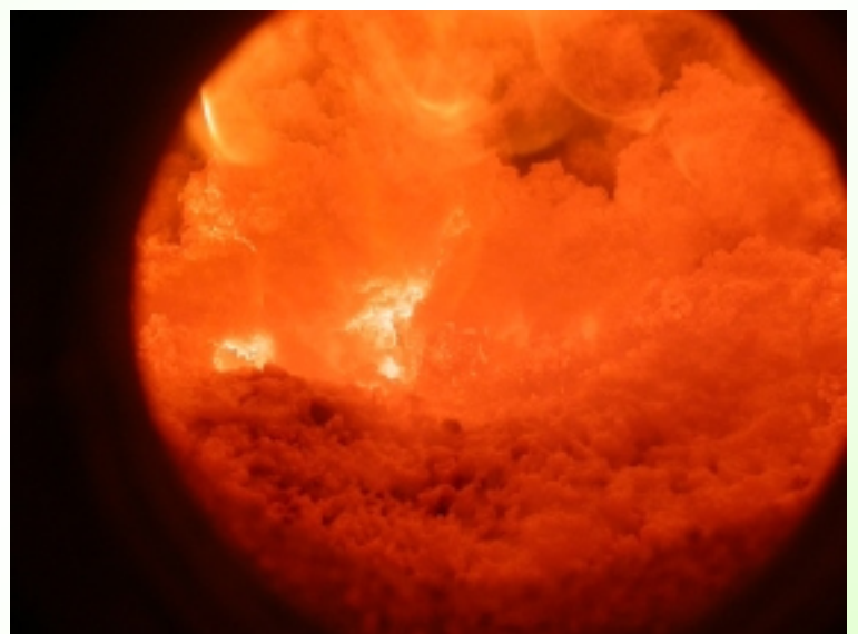
Blick in den Feuerraum einer Pilot-Rostfeuerung während eines Verbrennungstests
