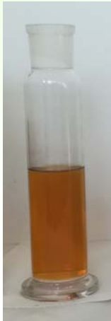
In Isopropanol gelöste Teere nach Gasprobenahme vor Katalysator
