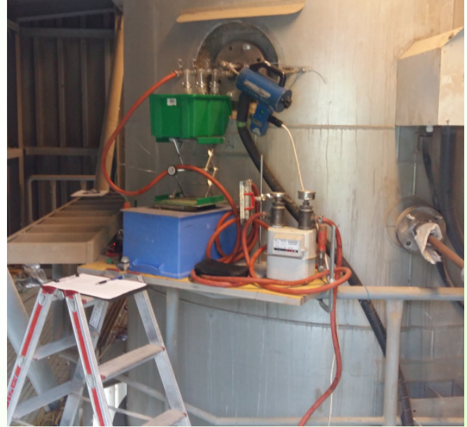
Gasprobenahme während eines Testlaufs an einer Biomasse-Feuerungsanlage
