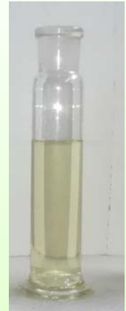
In Isopropanol gelöste Teere nach Gasprobenahme nach Katalysator
